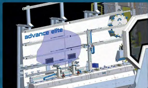
D-Shaping è il primo strumento che ti permetterà di lavorare vetri sagomati sul centro di lavoro verticale, provenienti direttamente dal banco di taglio.
